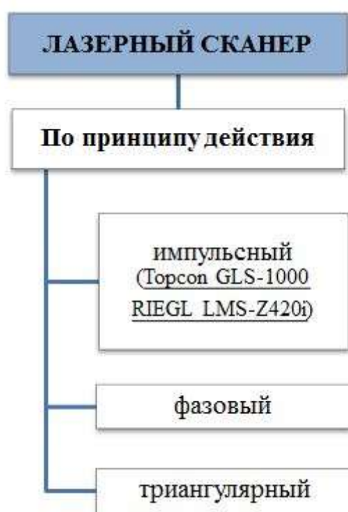
Рисунок 1 - Принципы действия лазерного сканера
